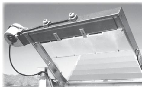
图7.四个喷嘴以0.20-0.25GPM的速率往样品上喷淋高纯度水。
