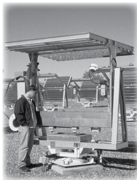
图8.在5度倒置锁定位置模拟夜晚样品表面上的露水形成,锁定位置便于样品安装和测量。
