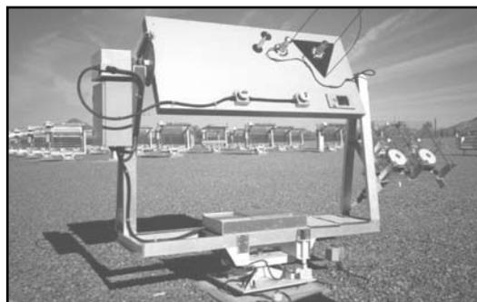
图11. 由一个装备有两个 Eppley TUVRs 和一个正入射日光辐照计的日光跟踪设备收集数据来计算辐射量。
