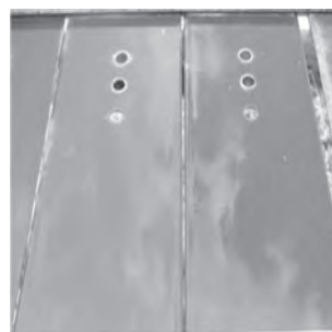
图10 在佛罗里达南部曝晒后，开裂和未开裂的涂层样品
