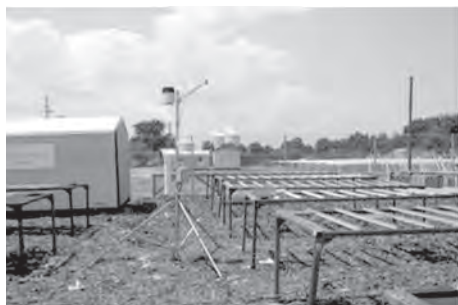
图5 佛罗里达测量水侵蚀的试验场 (注意在样品架旁边是气象站)
