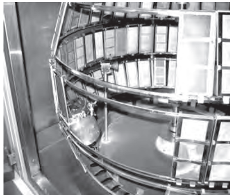
图2 转鼓式试验箱在加速老化测试期间收集从标准油漆试板上流下的水量的装置
