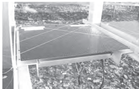
图6 用于水侵蚀研究的带有称重装置的油漆试板 (称重装置在水平油漆试板的下面)
