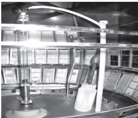
图1 转鼓式试验箱收集水的装置
