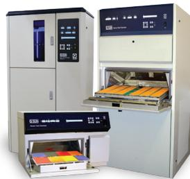
Las cámaras de ensayo Q-SUN con luz xenón son cámaras capaces de medir la resistencia a la luz y la durabilidad del color gracias a su capacidad de reproducir los daños ocasionados por el espectro de luz solar y la lluvia. Sus lámparas xenón proporcionan una mayor similitud al espectro de luz solar completo. Los filtros ópticos pueden durar indefinidamente (siempre y cuando se les aplique un uso normal).
