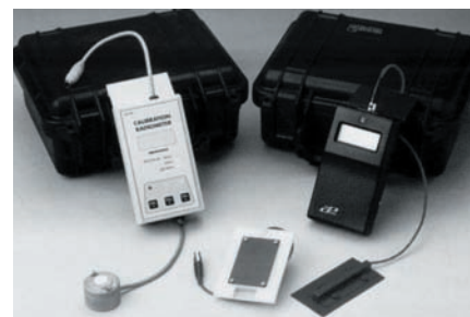
Con el radiómetro la calibración de la irradiación puede ser rápida y fácil.
