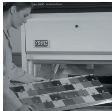
La bandeja deslizante para muestras del conjunto estático simplifica el montaje de las muestras.
