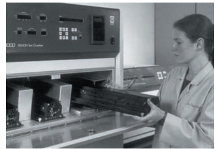
El acceso frontal facilita el reemplazo de las lámparas.
