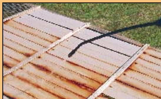
Prüflinge in beschleunigten Salzsprühnebel-Korrosionstests werden mehrmals pro Woche mit einer Salzlösung besprüht.
