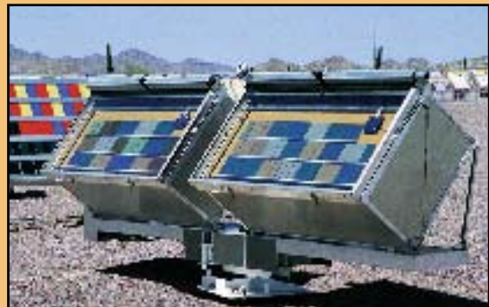
Diese AIM-Boxen in Arizona dienen zum Testen von Automobil-Innen-Materialien. Sie können große 3D-Teile wie Armaturenbretter aufnehmen.
