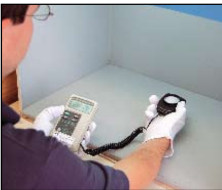
Prüfung der Lichtstärke mit Luxmeter vor visueller Bewertung
