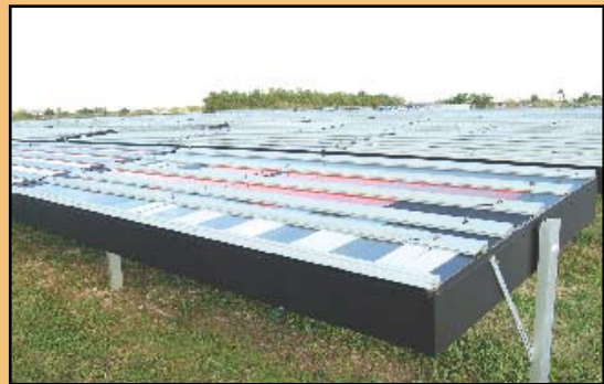
Hohe Temperaturen sind ein wesentlicher Faktor der Florida-Bewitterung. Eine Black-Box erhöht die Temperatur der Prüflinge noch mehr.
