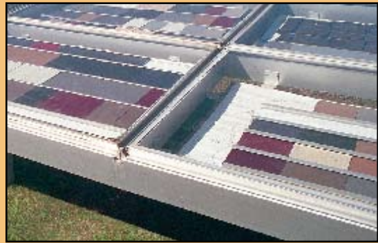
Unterrahmen mit Fensterglas zum Schutz von getesteten Innenmaterialien
