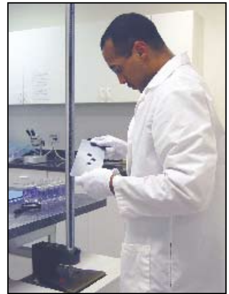
Stoßprüfung bei Q-Lab Florida
