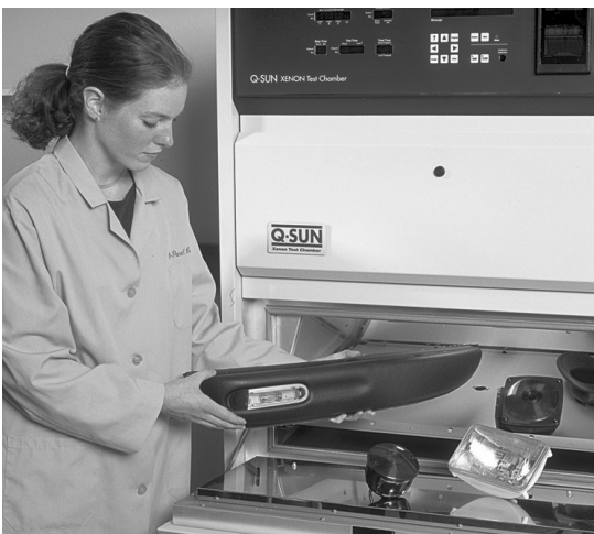
O Q-SUN Xe-3 acomoda peças 3-D, tubos de ensaio, placas, além de painéis planos.
