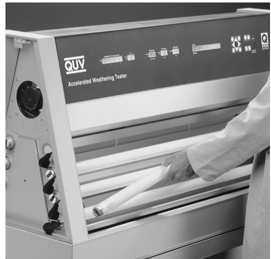
O modelo de QUV/se não requer rotação de lâmpada. Porém, quando for a hora de trocar lâmpada, os duplos acessos laterais tornam o trabalho fácil de executar.
