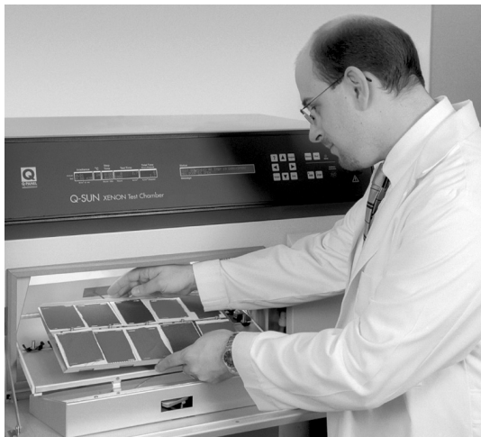
O Q-SUN Xe-1 permite montagem de amostras mais versáteis, incluindo peças 3D e painéis planos.
