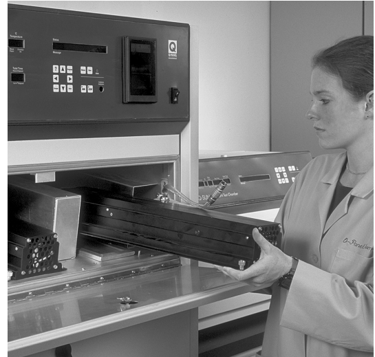
Substituição da lâmpada da Câmara Q-SUN é quase sem esforço: basta abrir a porta articulada, desconectar e deslizar a lâmpada para fora
