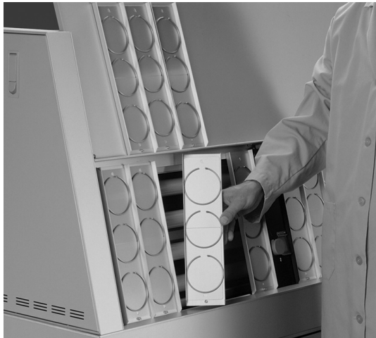
Um equipamento QUV tem cinco vezes a capacidade do Q-SUN Xe-1 e 1.5 vezes a capacidade do Xe-3.
