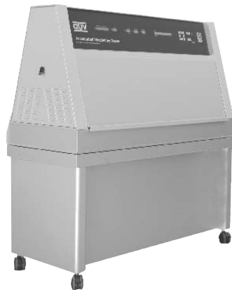
QUV/cw 和 QUV/se 功能相同，但改装成使用荧光冷白灯管进行加速测试。
