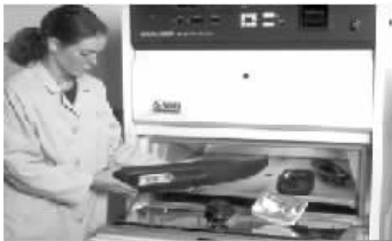
图 5 平板型氙灯试验箱可放置立体三维试样
