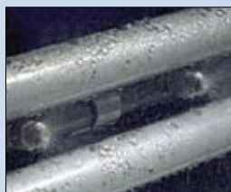
QUV/sprayは結露に加え、スプレー機能によって熱変化ショックと表面侵食を再現します。
