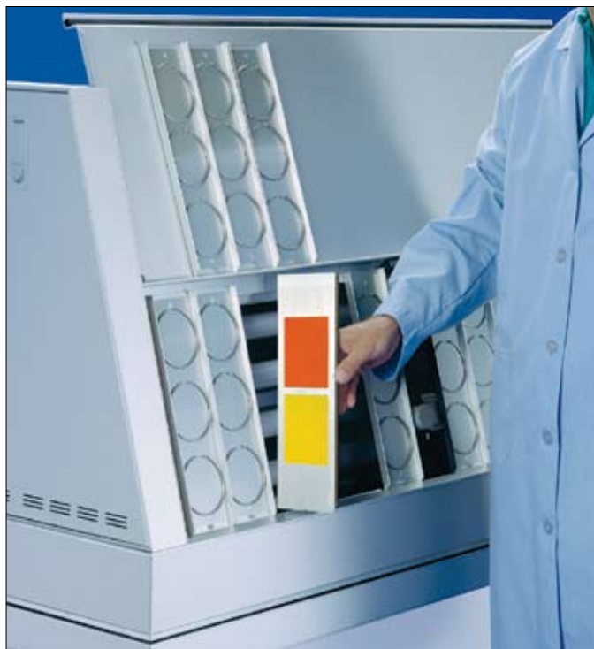
試料はQUVの前面と背面の両方に設置でき、高収容能力があります。
