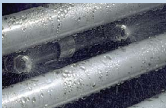
QUV/sprayは、熱変化ショックと物理的侵食の影響を再現します。
