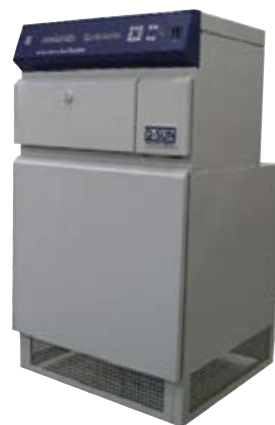
Q-Sun Xe-1-BC 可实现 15°C 的测试温度，制冷机作为氙灯试验箱的基座。
