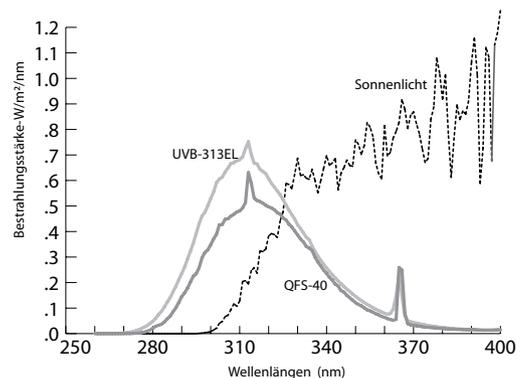
**UVB-Lampen stellen die kürzesten UV-Wellenlängen dar für eine maximale Beschleunigung.**
