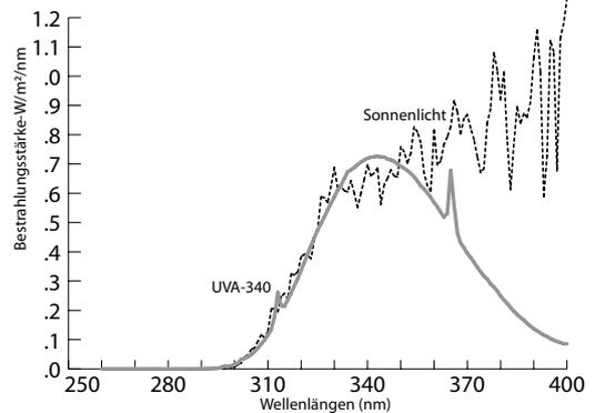
**UVA-340 Lampen bieten die bestmögliche Simulation von Sonnenstrahlung im kritischen, kurzwelligen UV-Bereich.**
