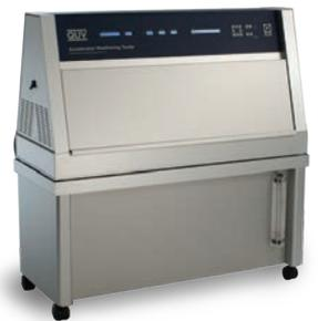
QUV通过紫外光照、高温凝露的循环测试，模拟户外老化效果。QUV中紫外荧光灯管模拟了阳光曝晒，冷凝和水喷淋逼真地再现了露水和雨水。使用者在几分钟内便可以完成设备的校准。简单且久经考验的设计使得QUV安装方便、易于使用、运行成本低廉，几乎不需要维护。在世界范围内数以千计的QUV被广泛使用，QUV是全球使用最广泛的老化试验机。
