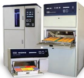
Q-SUN氙灯试验箱是测试耐光性、日晒色牢度和耐候性的试验箱，再现户外阳光曝晒和雨水带来的破坏。氙弧灯很好地模拟了全光谱太阳光。如果操作得当，滤光器可以长期使用。
