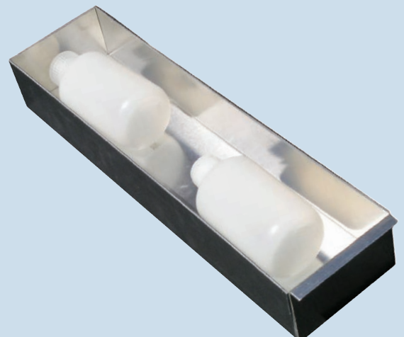
Das QUV kann eine Vielzahl von dreidimensionalen Prüflingen aufnehmen, beispielsweise Fahrzeugteile, Linsen, Flaschen und CDs.
