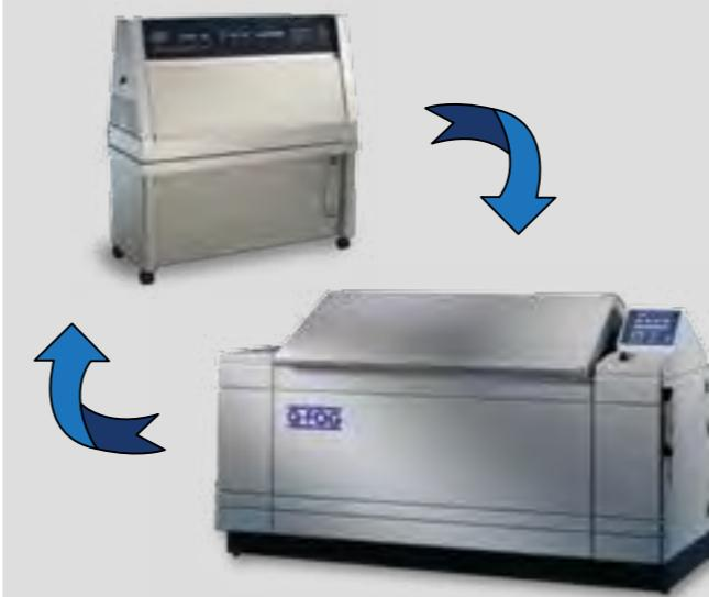
交替的QUV暴露和Q-FOG循环腐蚀试验可提高某些材料的相关性。
