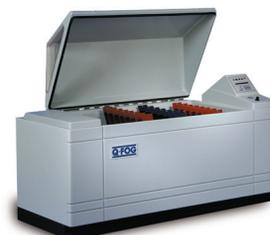
La gamme Q-FOG se décline en 2 volumes afin de répondre à différents besoins. Le volume utile a été optimisé, le capot est équipé d'un système à ouverture facile et le seuil de chargement est accessible facilement. Nos Q-FOG sont construits en suivant la ligne conductrice Q-Lab : simplicité, fiabilité, facilité de fonctionnement et faible coût de fonctionnement et d'entretien.
