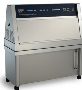
屋外劣化を再現するために、QUVテスターはコントロールされた紫外線照射や水分負荷並びに高温を交互に与えることが出来ます。これは、特殊な紫外線蛍光灯を用いて太陽光を再現し、現実的な露や雨を再現するために結露水並びに水スプレーを使用しています。装置の校正は、ユーザによって簡単に数分で行うことができます。このシンプルで実証済みの設計によって、容易なインストール、使い易さ、低ランニングコスト、ほぼメンテナンスフリーを得ることが出来ます。現在世界中で数千ものQUVが使用されており、世界で最も広く使用されている耐候性試験機となります。
