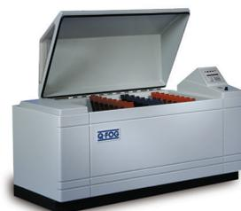
Q-FOGテスターは、広範なテスト要件を満たし、多くの業界標準に準拠するために、2つのサイズが利用可能です。Q-FOGテスターの内部ソリューションリザーバーは、スペース効率を最大化しメンテナンスの必要性を最小限にします。Q-FOGテスターのデザインは、槽の縁が低くなっており簡単に開閉できる蓋を採用しているので、簡単にサンプルを設置することが出来ます。Q-FOG複合サイクル試験機は先端の腐食試験技術、信頼性、操作のしやすさと容易なメンテナンスを非常に手頃な価格で提供しています。
