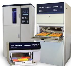
Q-SUNキセノンアーク耐候性試験機は、連続スペクトルを持った太陽光や雨による劣化を再現するフル機能の耐光、退色、光安定性試験機になります。このキセノンアークランプは、連続スペクトラムを持ち太陽光と最も近似しています。この試験機の光学フィルターは、通常の使用方法においては交換せず使用し続けることが出来ます。
