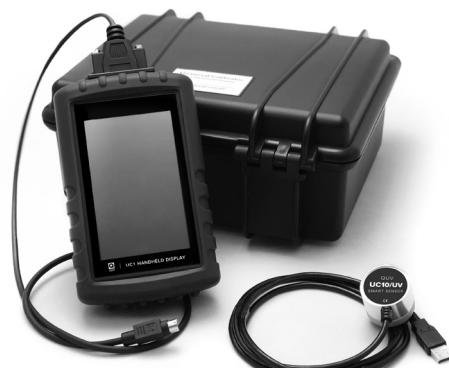
照度センサーは、ISO17025に準拠した再校正を行うために毎年交換してください。
