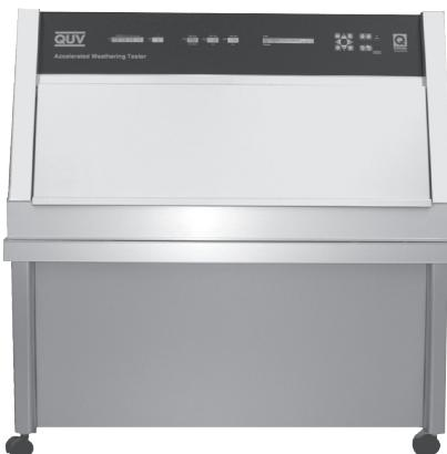
QUV試験機は、世界で最も広く利用されている耐候試験機です。耐久性のある素材の場合、短波UVがほとんどの風化損傷を引き起こすという概念に基づいています。
