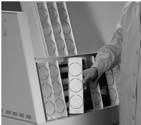
QUV促進耐候試験機は、蛍光UVランプを使用して、耐久性のある素材に対する太陽光の損傷効果を再現します。
