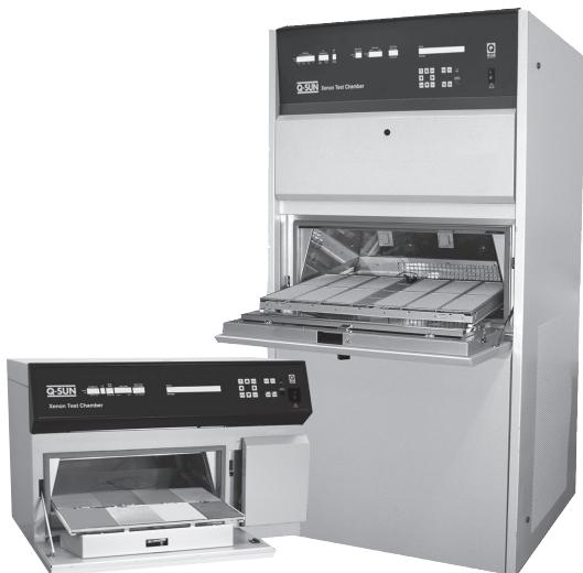
Q-SUNキセノン試験機は、紫外線、可視光線、赤外線を含む太陽光の全スペクトルを再現します。
