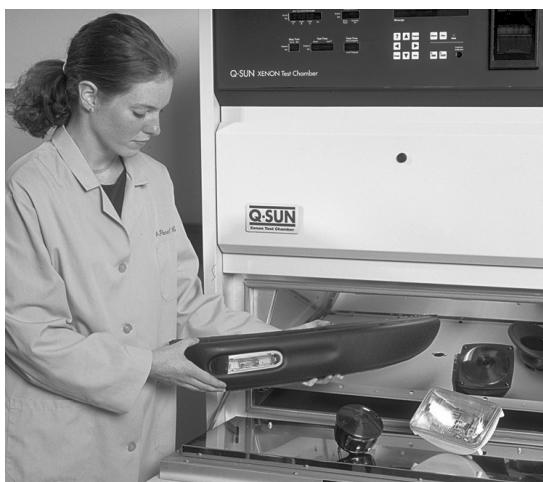
Q-SUN Xe-3は平面パネルの他に、立体部品、試験管、ペトリ皿を収納します。
