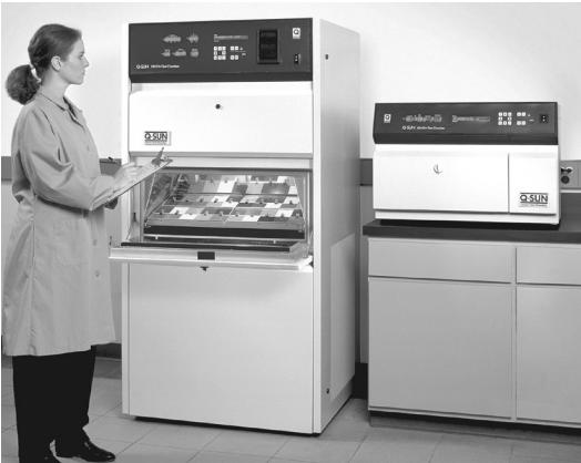
Q-SUNキセノンアーク試験機は、フルスペクトルの太陽光を再現し、不要な波長を取り除くためフィルターを通してします。
