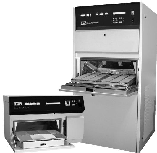
Q-SUNキセノンアーク試験機は、収容する試験片に合わせて、全機能装備モデルと卓上式モデルをご利用いただけます。
