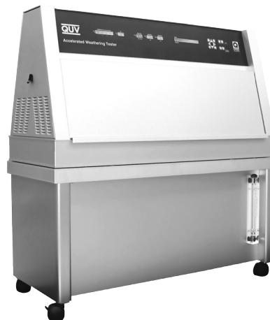
QUV促進耐候試験機は、蛍光UVランプを使用して、耐久性のある素材に対する太陽光の損傷効果を再現します。
