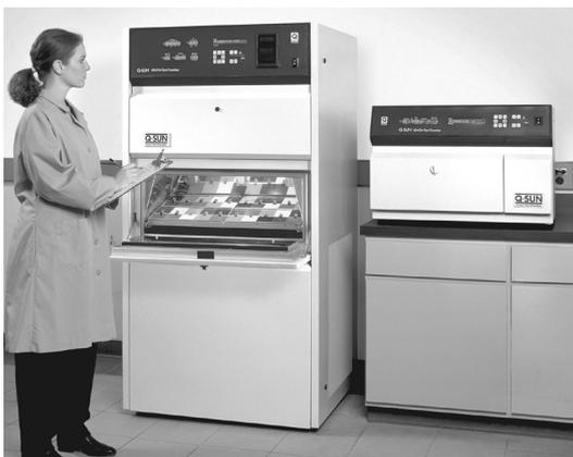
Q-SUNキセノンアーク試験機は、フルスペクトルの太陽光を再現し、不要な波長を取り除くためフィルターを通します。
