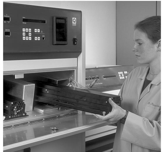
Q-SUN試験機のランプの交換は簡単です。ヒンジ式扉を開け、ランプを外してスライドさせます。
