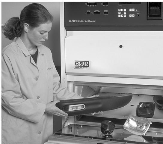
Q-SUN Xe-3は平面パネルの他に、立体部品、試験管、ペトリ皿を収納します。
