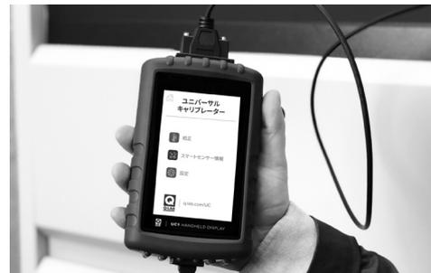
ユニバーサルキャリプレーター(UC)システムを用いれば、必要な校正を簡単に実行できます。
