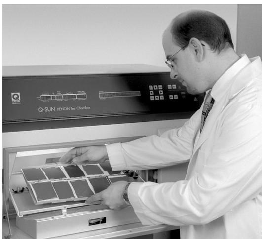
UVA-340ランプを使用することで、臨界短波UV領域で利用可能な最高の太陽光シミュレーションが行えます。
