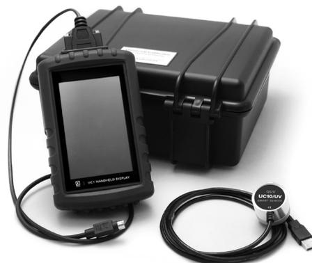
照度センサーは、ISO17025に準拠した再校正を行うために毎年交換してください。
